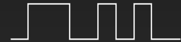
**Binary** 开关信号，信号量只有 ON 或 OFF 两种状态
