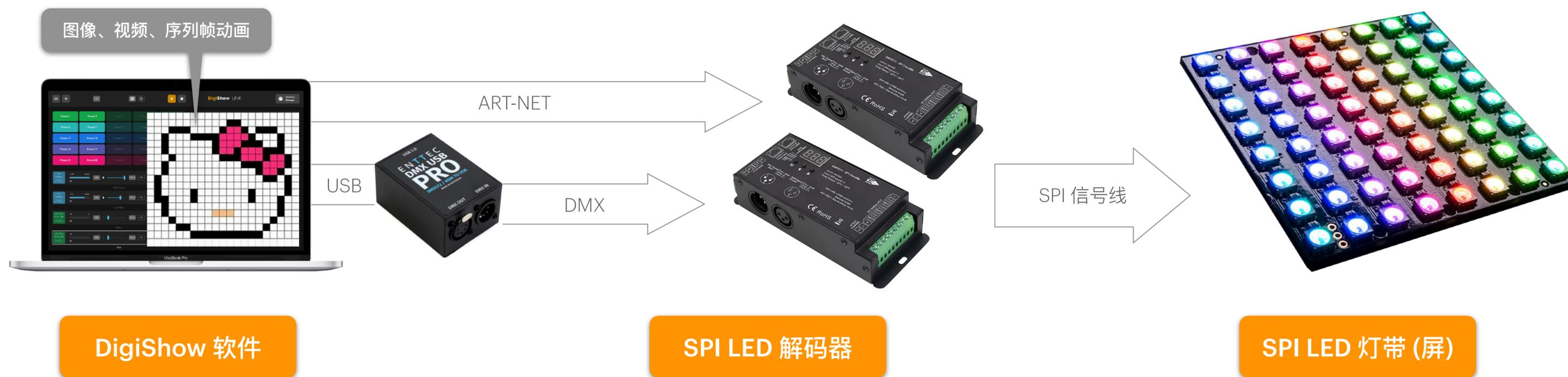
像素映射常应用于 SPI (如WS2812) 幻彩灯带的像素显示。灯带上的每个RGB像素占用三个 DMX 通道，DigiShow 将电脑中的图像编码成 DMX 通道数据，发送给 SPI LED 解码器以驱动灯带上各 RGB LED 灯的动态显示。
