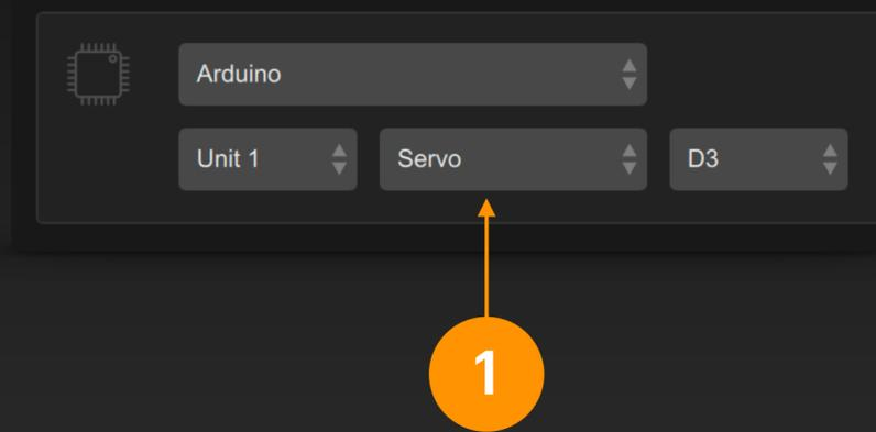
在信号条输出端中选择 Arduino 接口，选定一个引脚并设定它的类型为 Servo (舵机)。
