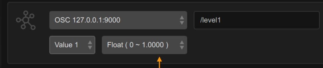
在信号条输出端中选择 OSC 接口，设定 OSC 地址和数据序号，选择数据类型为 Float (0~1.0000) (浮点数)。
