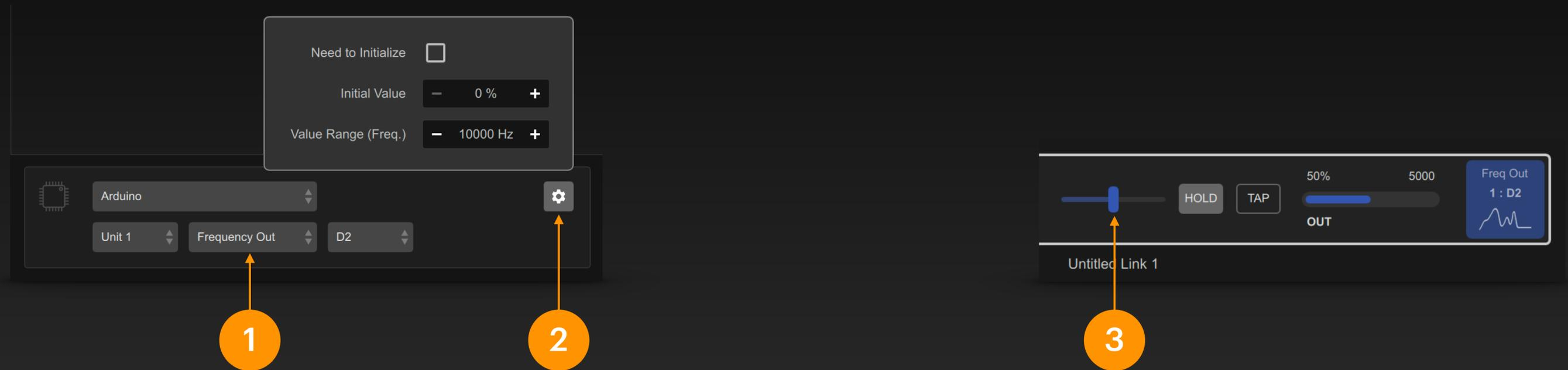
在信号条输出端中选择 Arduino 接口, 选定引脚并设定类型为 Frequency Out (频率输出)。
